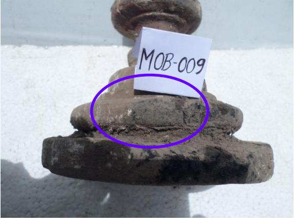
Incineración puntual del soporte estructural
