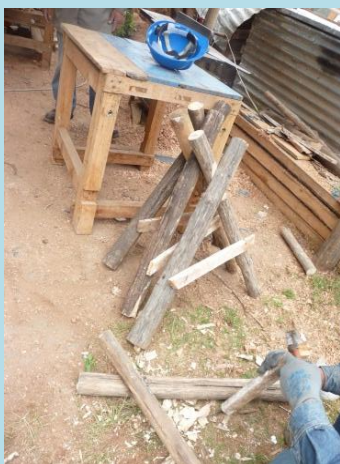
Confección de mesas de trabajo a base de madera eucalipto y madera aguano
