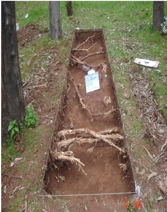
**FOTO. 15.-** Trinchera N°9, se observa las raíces de eucalipto en el área excavada.
