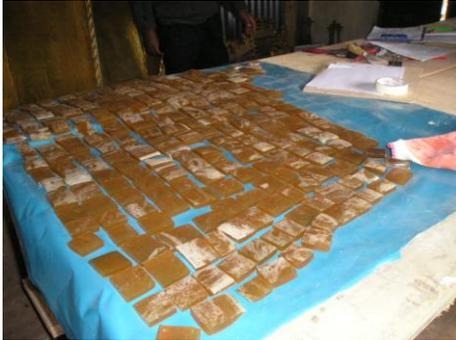
**Fotog. 150 y 151 :** Coletta preparada y en proceso de secado; al otro lado, tamizado de cal hidratada.
